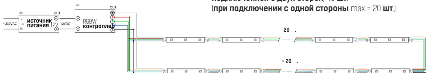
Максимальное количество модулей в одной цепи, подключенной с двух сторон, 40 шт.
